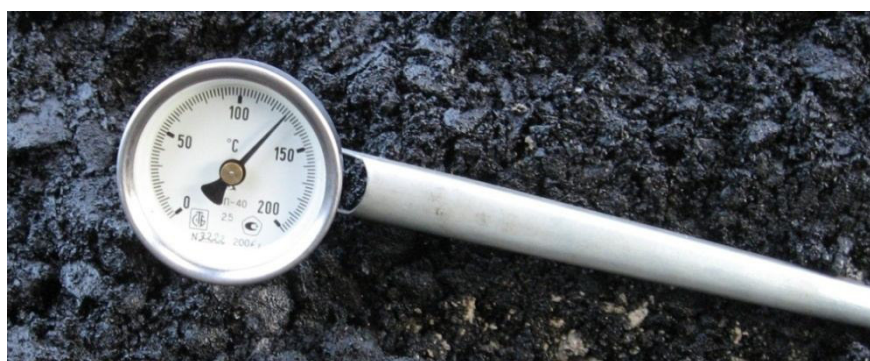
Рис. 3. Измерение температуры асфальтобетонной смеси термометром ТБП-40
