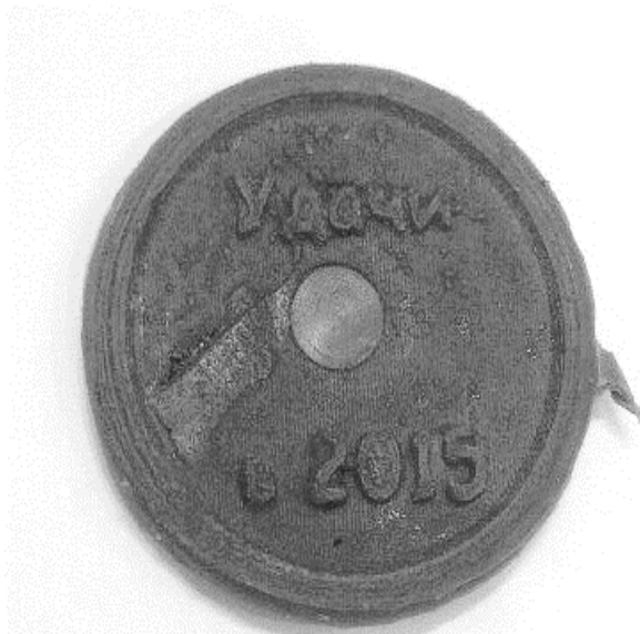
Рис. 6. Отливка изделия из полипропилена в металлополимерной матрице
