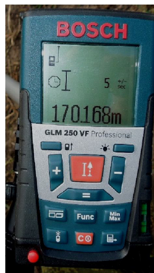
Рис.1. Измерение длины участка: а – дальномер на штативе; б – значение измеренной дальности
