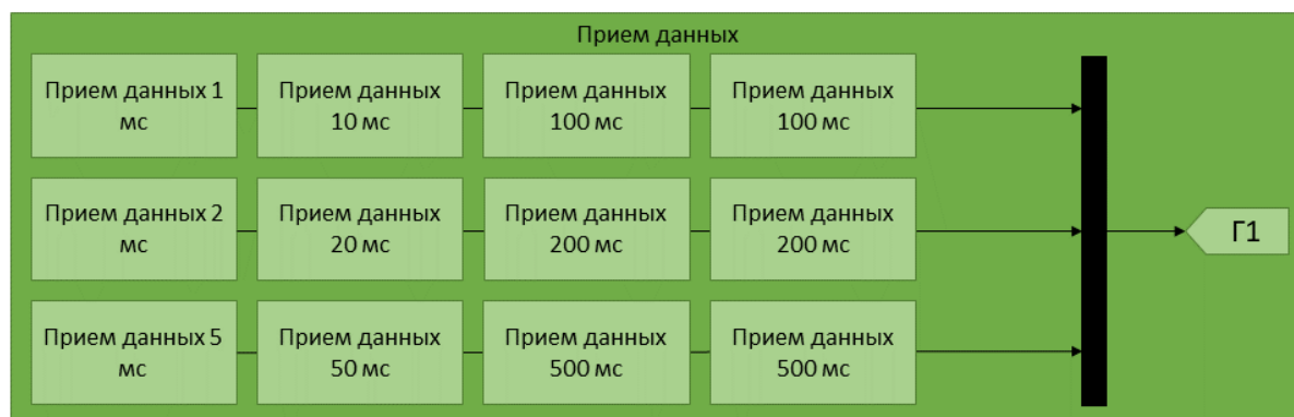
Рисунок 2 – Функциональная схема группы приема данных (Г1) Источник: составлено авторами.
