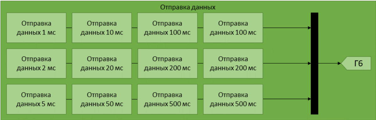
Рисунок 7 – Функциональная схема группы отправки данных (Г6) Источник: составлено авторами.
