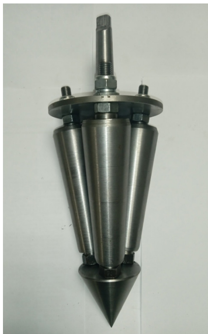
Рисунок 9 – Экспериментальный образец нового устройства для глубокого уплотнения грунтов Источник: составлено авторами.
