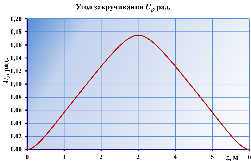
Рисунок 6 – График функции угла закручивания сечения Источник: составлено авторами.
