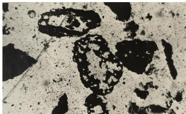
Рисунок 2 – Микрофотография частиц коксового остатка из золы-уноса (шлиф, ув. X 300) Источник: составлено автором.
