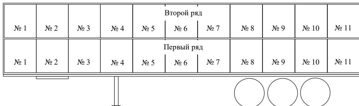
Рисунок 4 – Расположение грузовых мест в полуприцепе-птицевозе ТОНАР-98882 для размещения транспортировочных контейнеров
