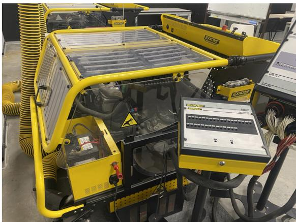
Рисунок 1 – Стендовый бензиновый двигатель внутреннего сгорания TU5JP4 производства PSA
