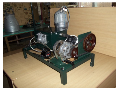
Рис. 1 Экспериментальная установка для обработки центрифуг ЯМЗ
