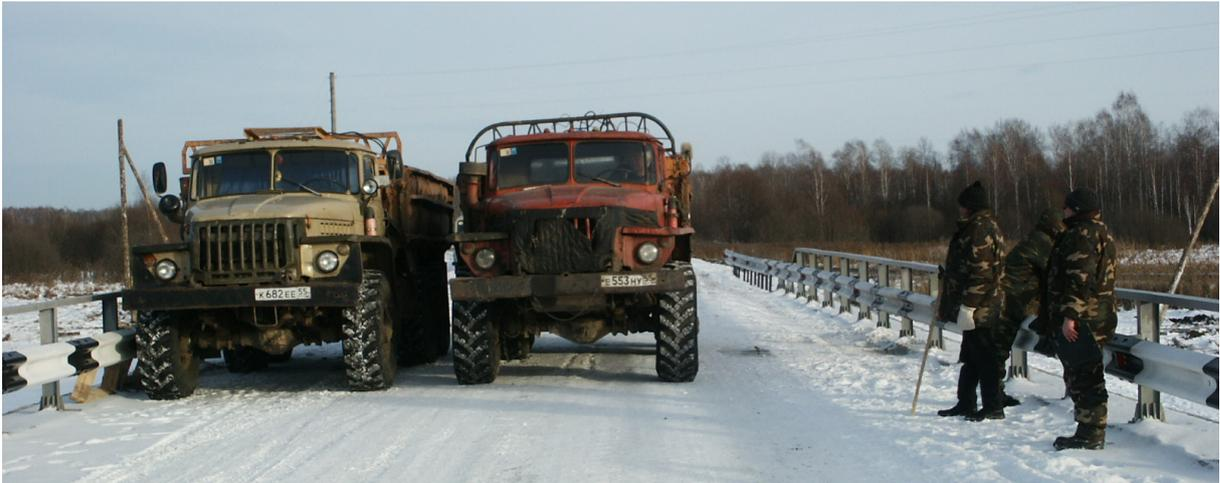
*Рисунок 4 – Испытание моста через р. Нягов.
