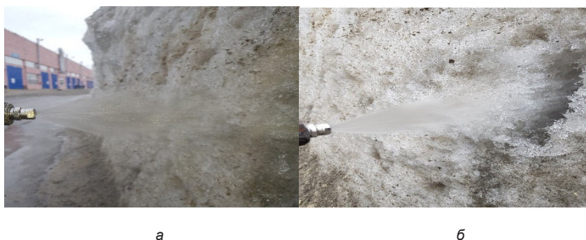
Рисунок 4 – Общий вид воздействия на снежный массив: а – форсунка с углом распыла 65°; б – форсунка с углом распыла 30° Источник: составлено авторами.
