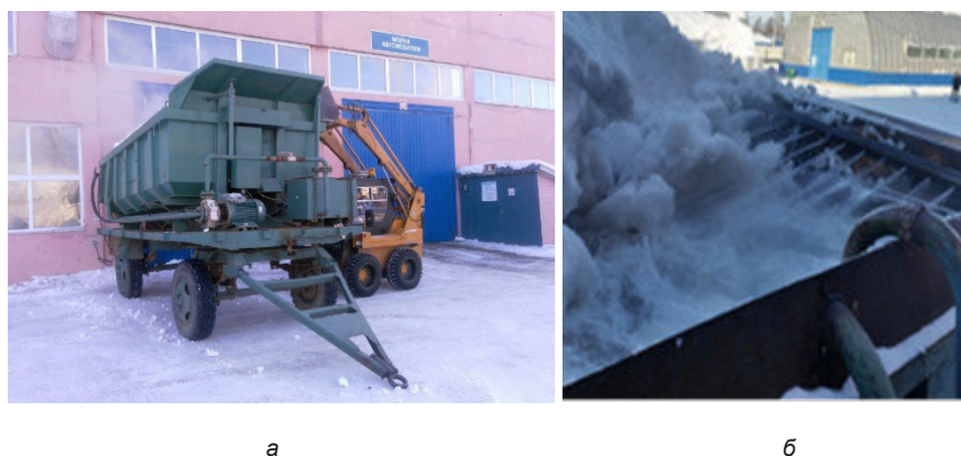
Рисунок 1 – Снегоплавильная установка на базе автоприцепа: а – общий вид установки; б – общий вид рабочего процесса Источник: составлено авторами.
