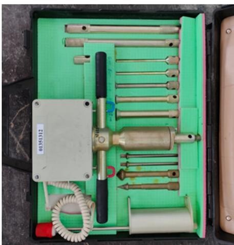
Рисунок 4 – Универсальный пенетрометр ПУС-3М, общий вид
