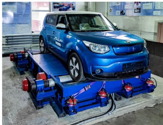
Рисунок 7 – Автомобиль *Kia Soul EV* на исследовательском стендовом комплексе ИРННТУ<sup>13,14</sup> [12]
