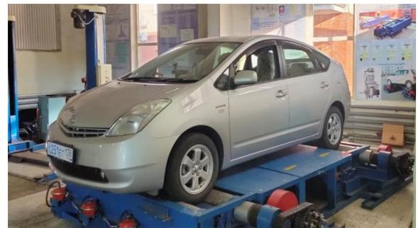
Рисунок 9 – Автомобиль Toyota Prius NHW20 на исследовательском стендовом комплексе ИРННТУ<sup>15</sup> [13,14]
