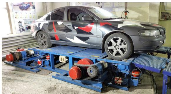
Рисунок 5 – Внешний вид КТС Volvo S60 2.5T AWD, установленного на полноопорный стенд с беговыми барабанами ИРННТУ
