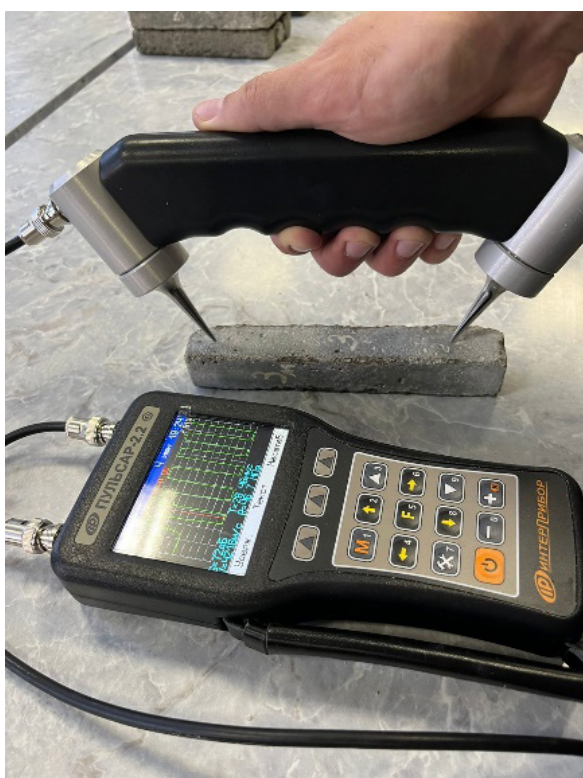
Рисунок 3 – Диагностика корродированного образца состава 1:5, твердевшего 13 мес в 1,5%-м р-ре MgSO_4 Источник: составлено авторами.
