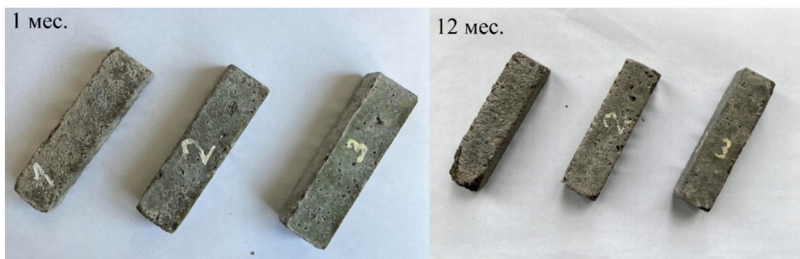
Рисунок 4 – Внешний вид образцов, твердевших в 1,5%-м р-ре \text{MgSO}_4 1 и 12 мес. Состав: 1 – 1:9, 2 – 1:7, 3 – 1:5 Источник: составлено авторами.
