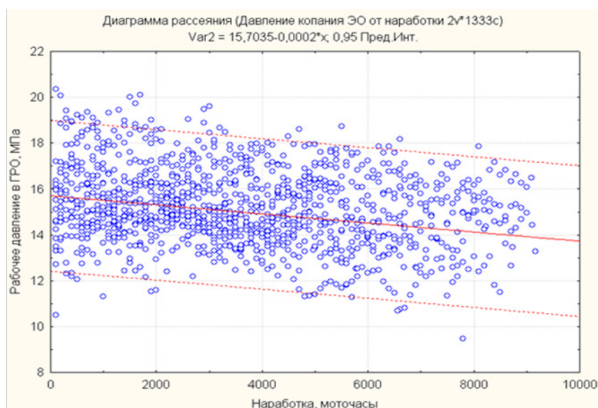
Рисунок 2 – Изменение давления в ГРО при разработке и наборе грунта ЭО марки ZX 330 с течением наработки (доверительные границы указаны с вероятностью 0,95) Источник: составлено авторами.
