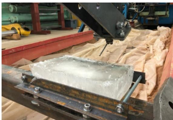
Рисунок 3 – Режущий элемент на установочной площадке
