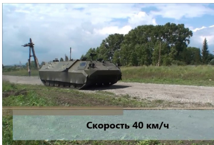
Рисунок 9 – Пробеговые испытания ВГМ с ЭМТ Источник: составлено авторами.
