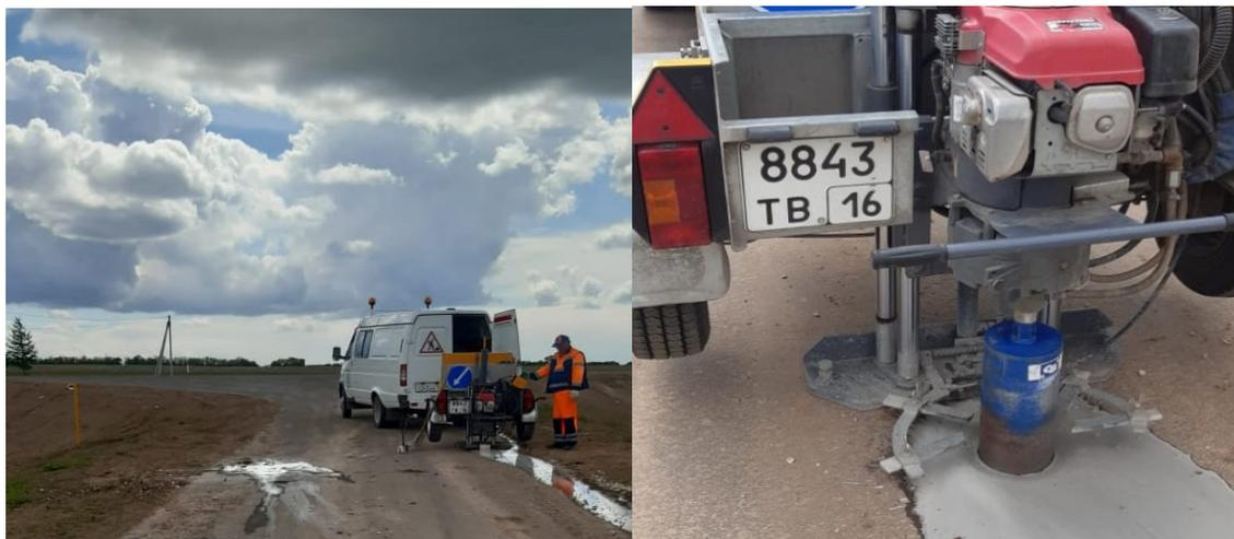
Рисунок 1 – Отбор кернов дорожного основания из щебня М 400, обработанного портландцементом и цеолитом
