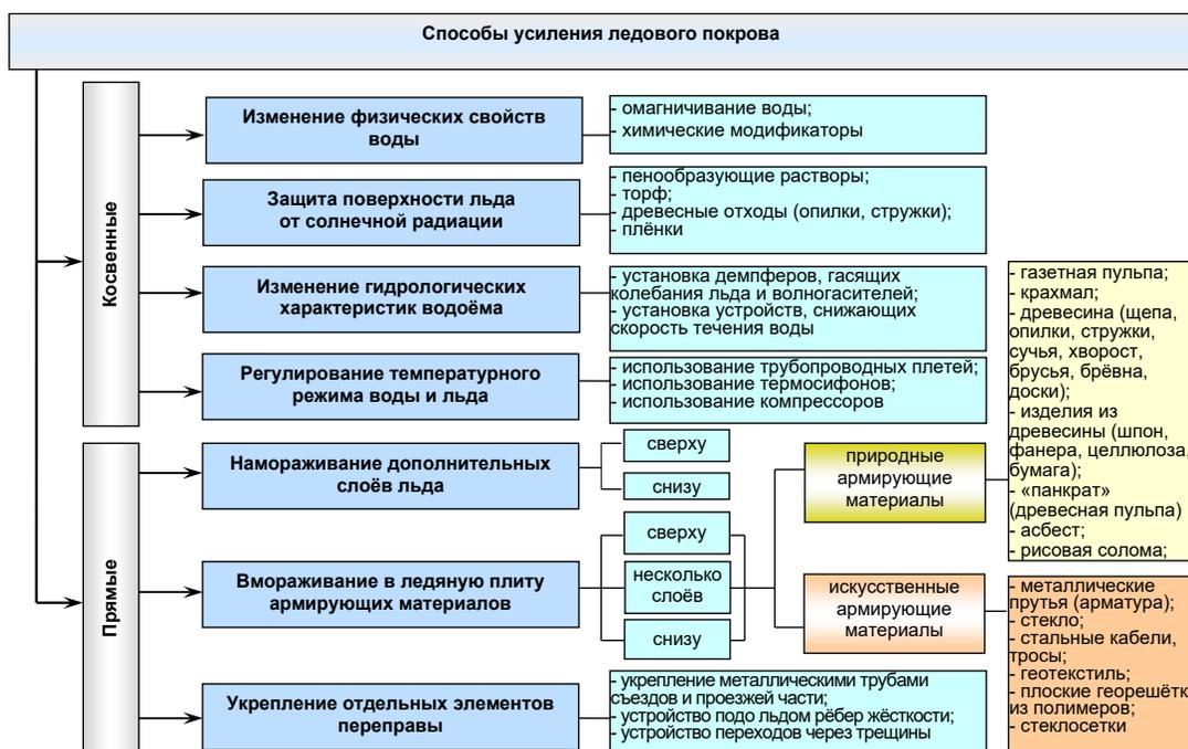
Рисунок 1 – Классификация способов увеличения несущей способности ледового покрова и продления сроков эксплуатации переправ
