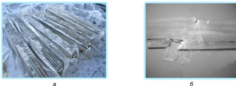
Рисунок 8 – Особенности разрушения армированного льда:
