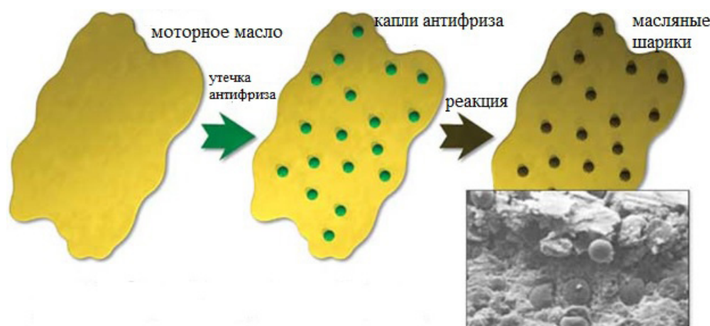
Рисунок 2 – Механизм образования масляных шариков из-за загрязнения картерного масла гликолем [14]
