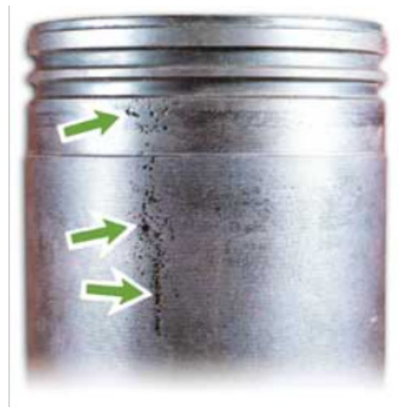
Рисунок 1 – Кавитационная эрозия стенки цилиндра [14]
