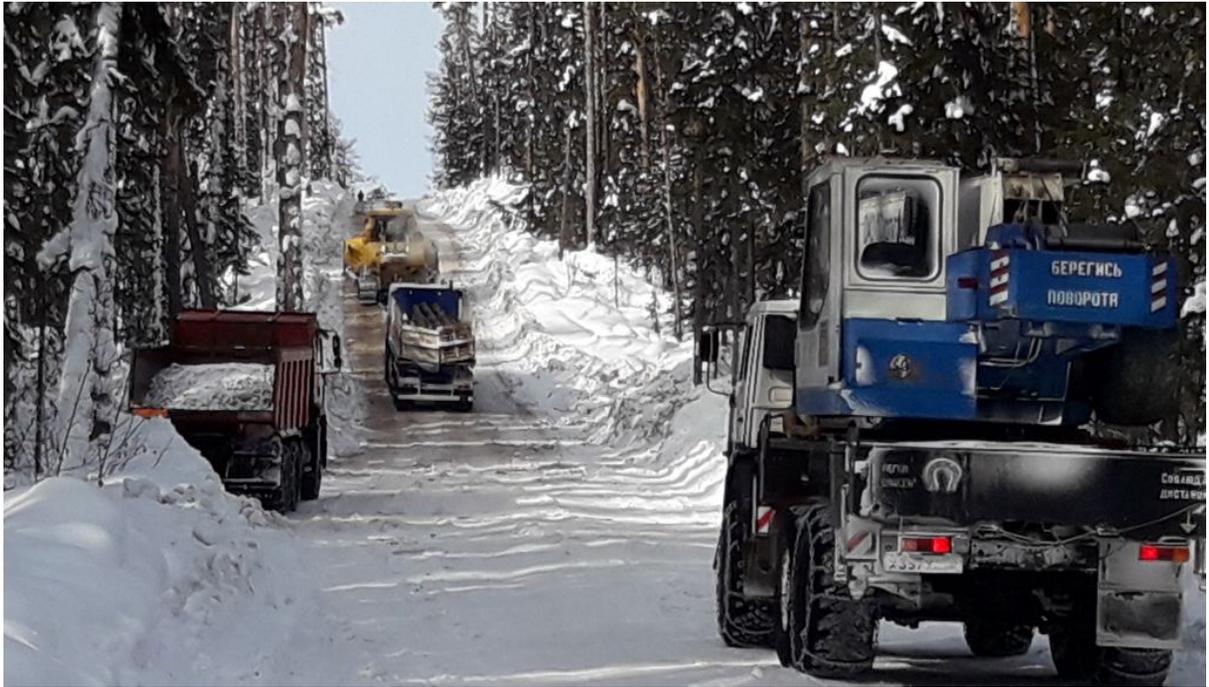
Рисунок 3 – Применение тракторной техники в качестве тягача для перемещения грузового автомобильного транспорта в суровых условиях Крайнего Севера (Республика Саха [Якутия])
