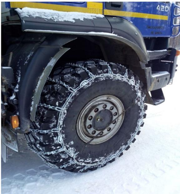
Рисунок 1 – Внешний вид колеса грузового автомобиля с цепью против скольжения для движения на участках дорог с подъемами и спусками в суровых условиях Крайнего Севера (Республика Саха [Якутия])
