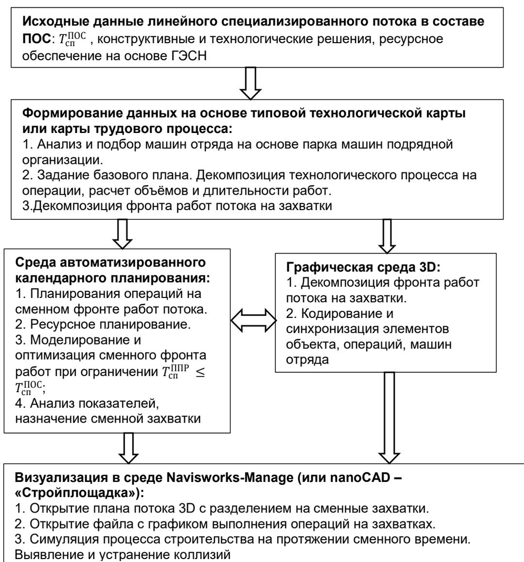
Рисунок 1 – Блок-схема моделирования специализированного линейного потока в компьютерной среде
