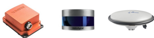
Рисунок 13 – Набор сенсоров для сбора лидарной карты: инерциальное устройство IMU Xsens-GTi-710 (слева), лидар Velodyne VLP32 (в центре) и приемник GPS сигнала «Ориент» (справа) Источник: составлено авторами.
