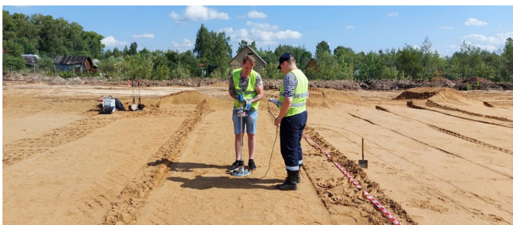
Рисунок 3 – Измерение модуля динамического нагружения грунта установкой ZORN ZFG3.0 Источник: составлено авторами.
