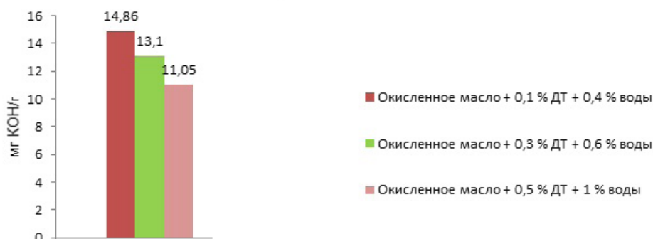
Рисунок 7 – Сравнительные значения кислотных чисел окисленного моторного масла Gazpromneft Diesel Ultra 10W–40 с различными концентрациями дизельного топлива и воды Источник: составлено авторами.
