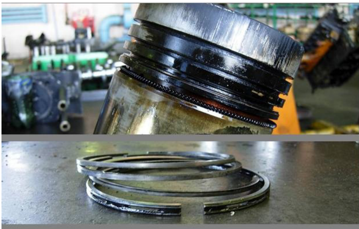
Рисунок 2 – Отложения на поверхностях деталей цилиндро-поршневой группы Источник: составлено авторами.
