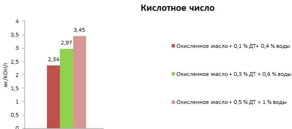
Рисунок 6 – Сравнительные значения кислотных чисел окисленного моторного масла Gazpromneft Diesel Ultra 10W-40 с различными концентрациями дизельного топлива и воды Источник: материалы соавторов.
