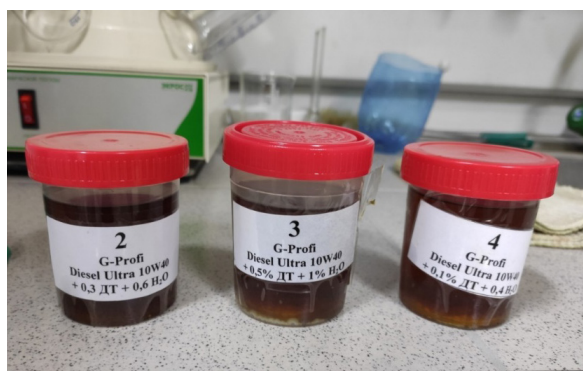
Рисунок 4 – Результат окисления моторного масла Gazpromneft Diesel Ultra 10W-40 с различными концентрациями дизельного топлива и воды при 95 °C и в течение 5 ч Источник: составлено авторами.
