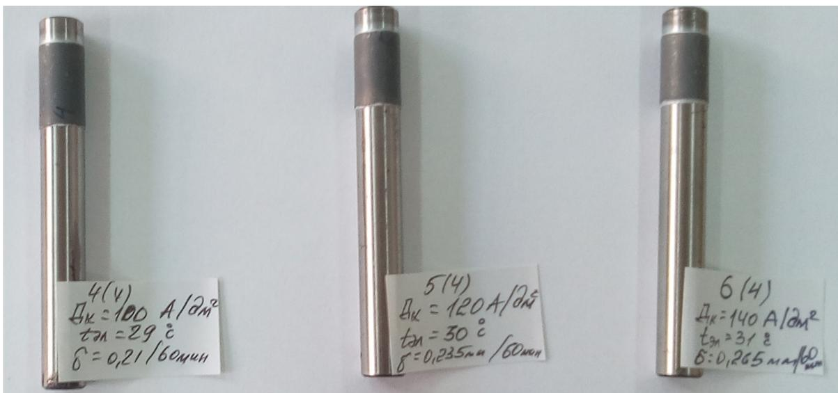
Рисунок 1 – Образцы для исследования прочности сцепления на различных режимах
