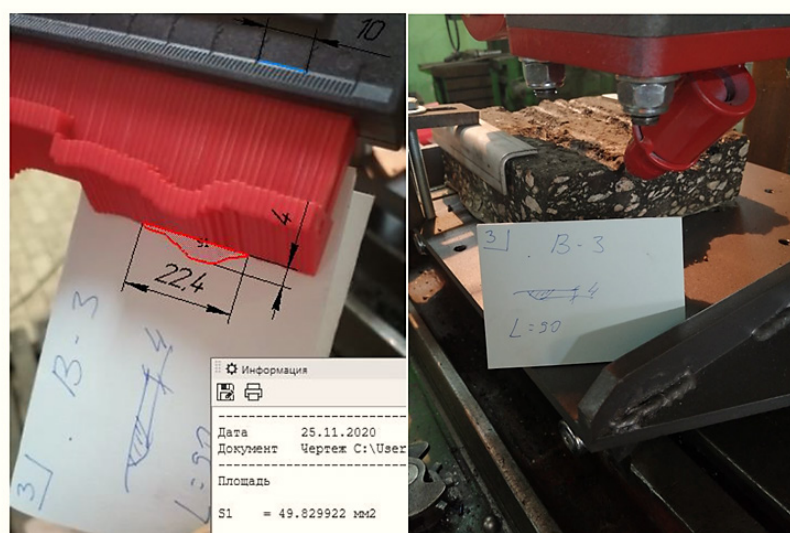
Рисунок 7 – Пример определения площади сечения стружки Источник: составлено авторами.
