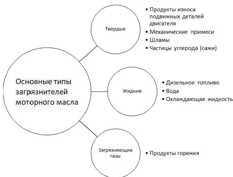
Рисунок 1 – Основные типы загрязнителей моторного масла
