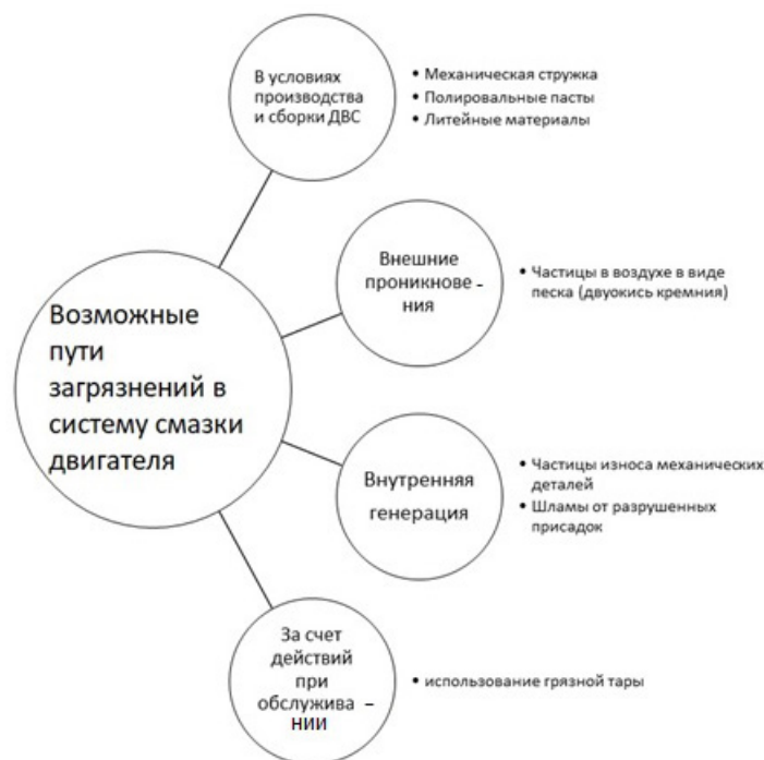
Рисунок 2 – Пути попадания твёрдых загрязнителей в моторное масло
