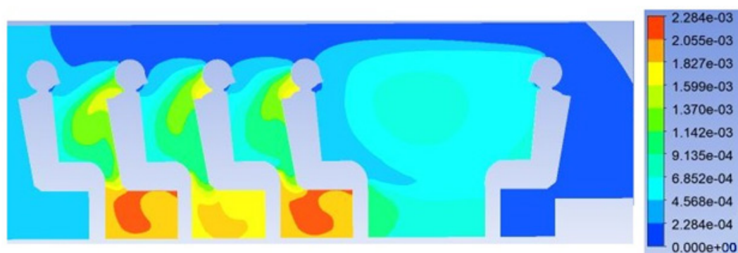
Рисунок 7 – Распределение значений газов в воздухе в салоне колесного транспортного средства после 100 с вычислений: а – \text{CO}_2 , %; б – \text{H}_2\text{O} , %
