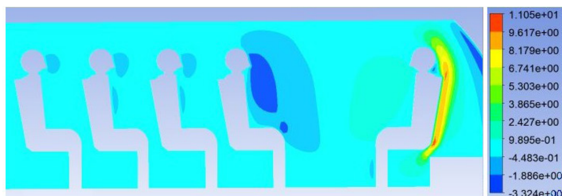
Рисунок 4 – Распределение значений проекции вектора скорости воздуха, v , m/s, при учете изменения газового состава в выдыхаемом пассажирами воздухе в салоне колесного транспортного средства после 100 с вычислений
