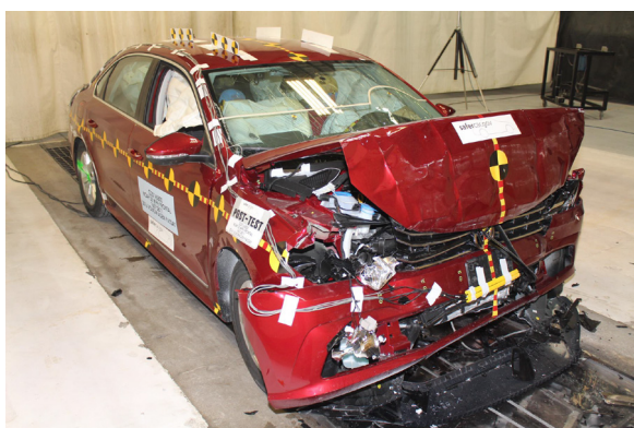
Рисунок 1 – Автомобиль Volkswagen Passat, получивший в рамках краш-теста деформации по всей ширине передней части кузова
