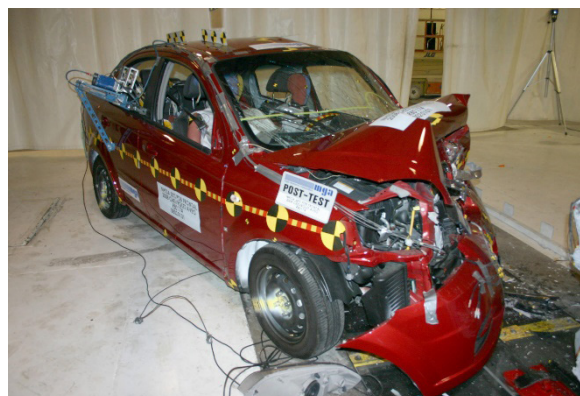
Рисунок 4 – Автомобиль Chevrolet Aveo, участвующий в краш-тесте с 50%-ным перекрытием (деформирующие силы были приложены только к половине фронтальной части)
