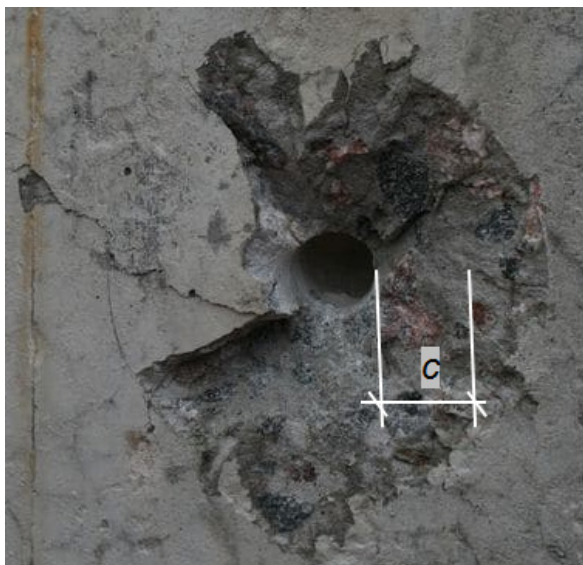
Рисунок 3 – Выкалывание бетона при испытании на отрыв со скалыванием
