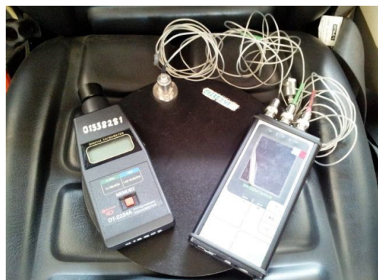
Рис. 2. Общий вид измерительных приборов: виброизмерительная аппаратура ЭКОФИЗИКА – 110А (HF) с датчиками VIBRATION TRANSDUCER AP 98-100-01; цифровой тахометр DIGITAL TACHOMETER DT-2234A
