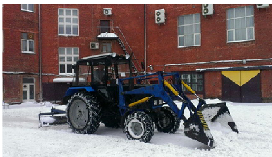
Рис. 1. Уборочно-подметальная машина на базе трактора МТЗ 80
