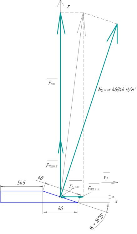
Рисунок 3 – Схема условных сил воздействия фаски нижнего ножа на грунт
