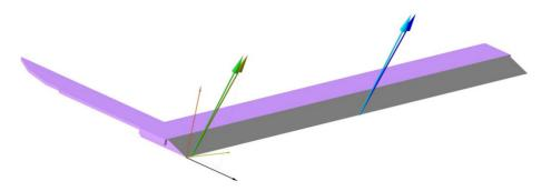
Рисунок 2 – Схема суммарных сил воздействия кромки нижнего ножа на грунт
