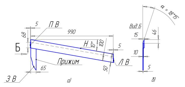
Рисунок 1 – Нижний нож с прижимом: а- вид снизу; б – вид Б
