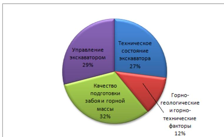
Рисунок 2 – Факторы, влияющие на работоспособность экскаватора
