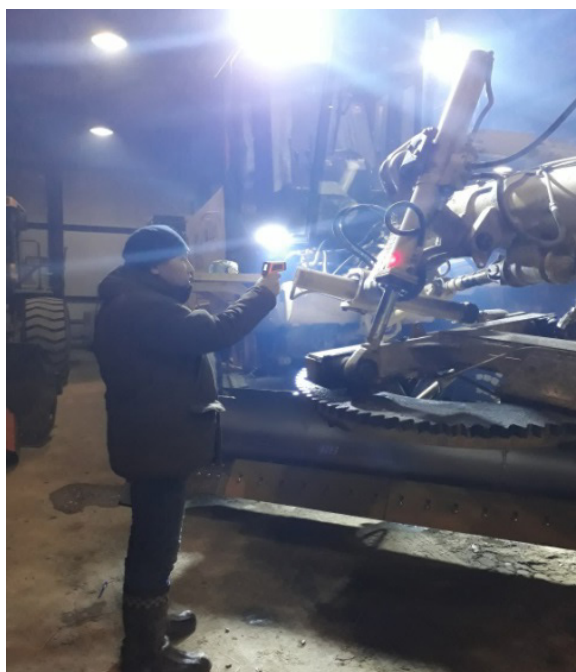
Рисунок 2 – Измерение температуры цилиндра
