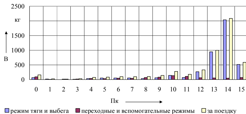
Рис. 3. Распределение расхода топлива дизелем тепловоза за поездку по позициям контроллера в четном направлении
