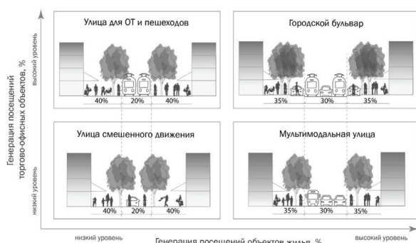
Рисунок 3 – Базовые варианты поперечных профилей для уличного пространства смешенного типа застройки городского центра Illustration 3 – Basic versions of the transverse profiles for street space mixed type of the urban development
