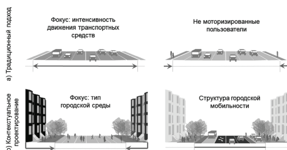
Рисунок 1 – Сравнение подходов к проектированию городских улиц, иллюстрация представлена с использованием графического материала руководства по проектированию городских улиц Бостона, США [3] Illustration 1 – Comparison of approaches to the city streets, illustration is presented using the graphic material of the manual on the design of city streets in Boston, the USA
