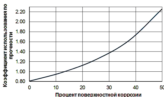
Рисунок 5 – Зависимость коэффициента использования по прочности нижнего пояса от степени коррозионных повреждений
