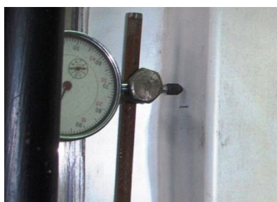
Рис.5 .Потеря местной устойчивости профилем А-Н107 t=0.7 мм.
