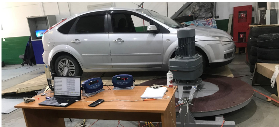
Рисунок 2 – Автомобиль Ford Focus в процессе испытаний на стенде Источник: составлено авторами.
