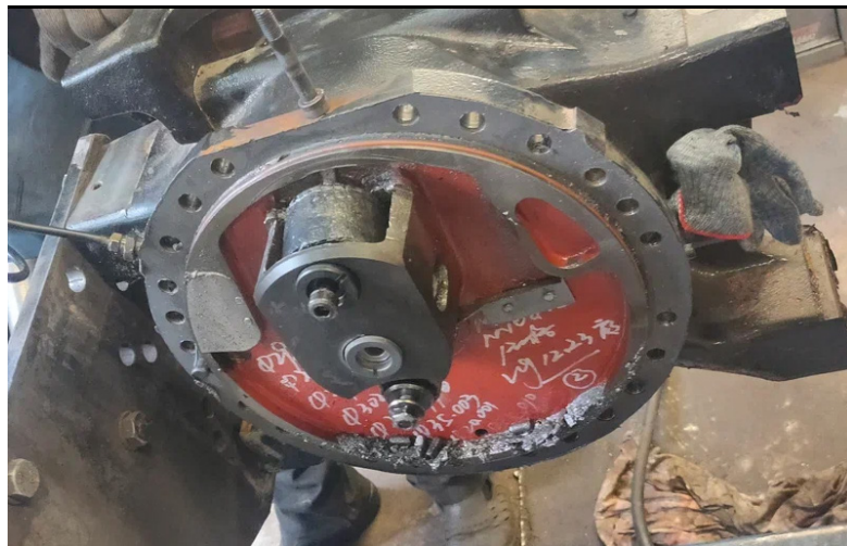
Рисунок 2 – Разрушение тягового привода вследствие усталостного выкрашивания (питтинга) беговой дорожки, интегрированной в тело шестерни Источник: авторские фотографии, сделанные в рамках научно-исследовательской работы по диагностике тяговых электроприводов.
