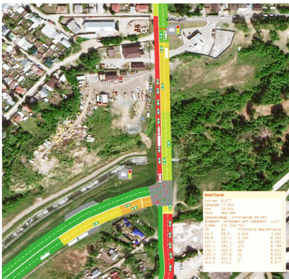
Рисунок 2 – Имитационные модели утренней дорожной обстановки: а – исходная; б – оптимизированная Источник: составлено авторами.
