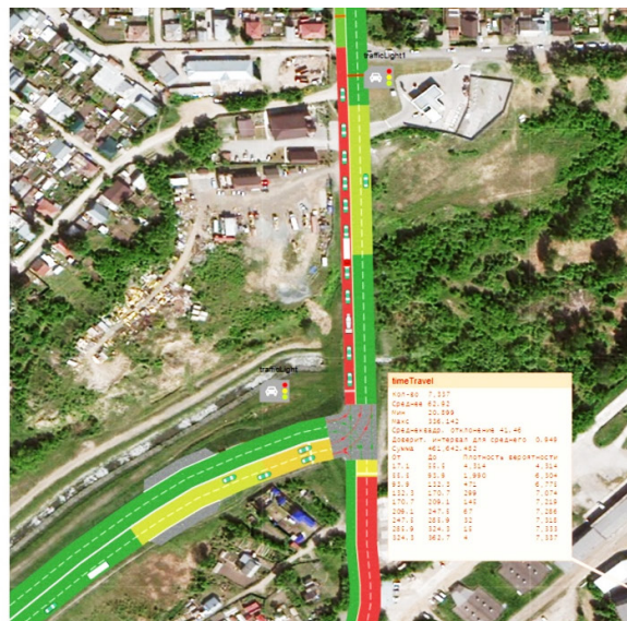
Рисунок 2 – Имитационные модели утренней дорожной обстановки: а – исходная; б – оптимизированная Источник: составлено авторами.
