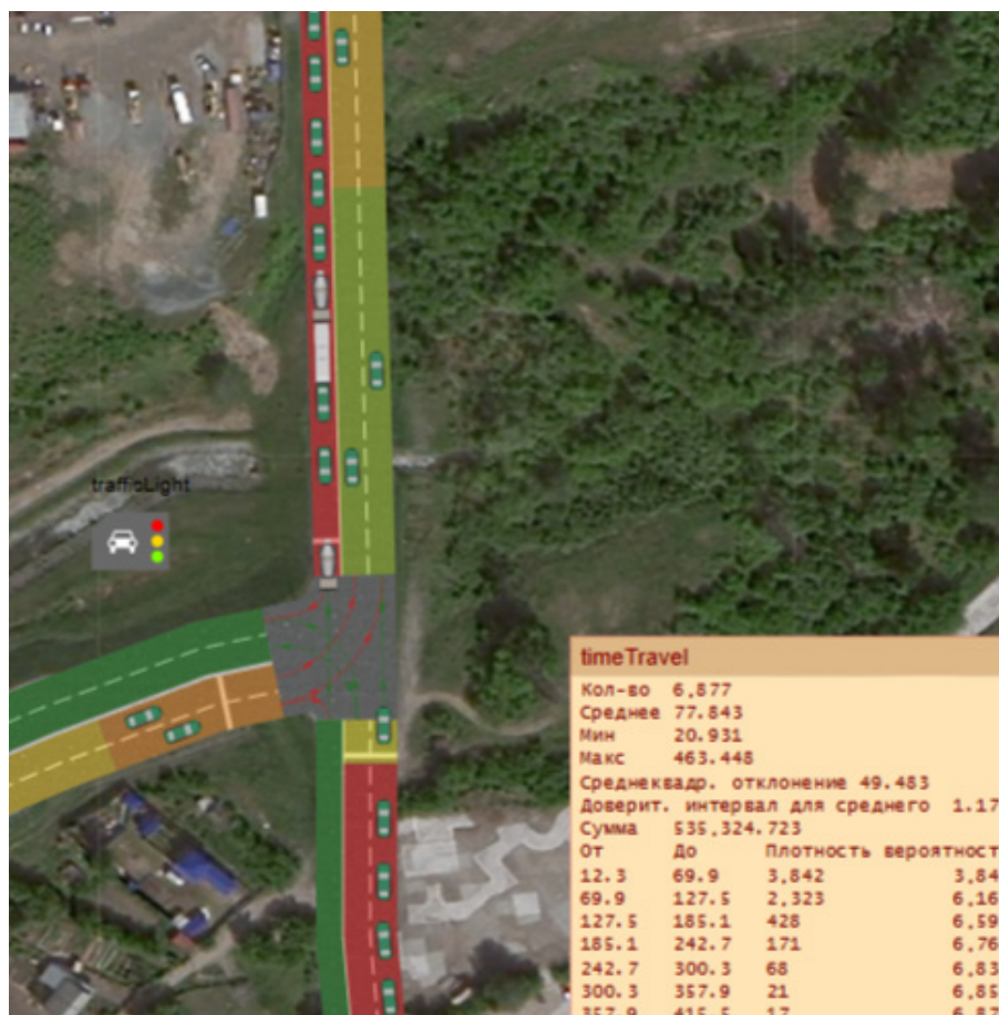
Рисунок 3 – Исходная имитационная модель с использованием реверсивного движения Источник: составлено авторами.
