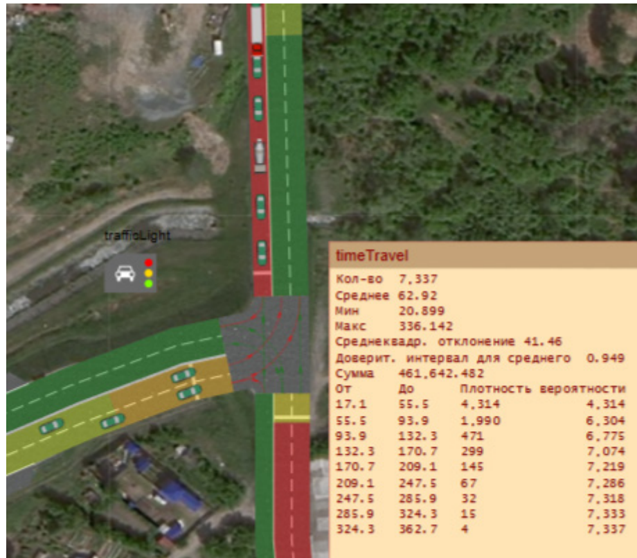
Рисунок 5 – Оптимизированная имитационная модель с использованием реверсивного движения Источник: составлено авторами.
