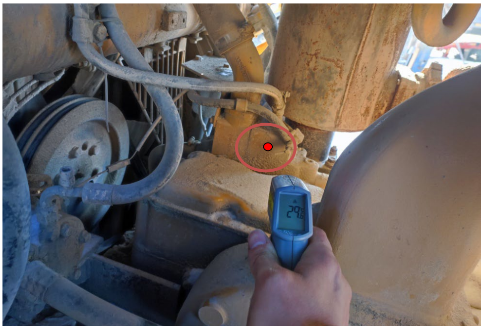
Рисунок 4 – Измерение температуры ОЖ в области термостата Источник: составлено авторами.
