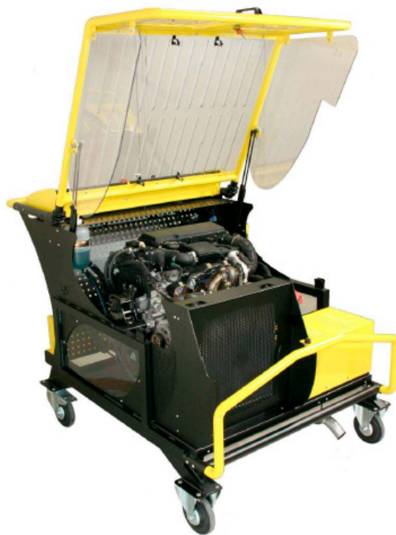
Рисунок 1 – Стендовый дизельный двигатель Источник: интернет-ресурс 1 .
