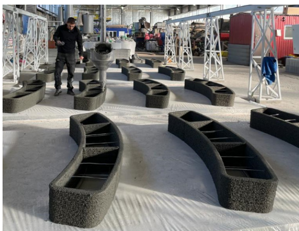
Рисунок 6 – Результат печати основания МАФ разработанной составом 4a Источник: Бетоник-Арт (г. Белгород).
