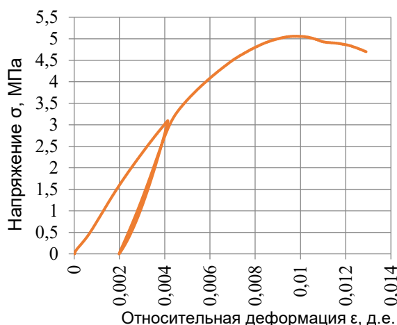
Рисунок 9 – Определение модуля упругости золошлаковой смеси, укрепленной известью 7% Источник: составлено авторами.
