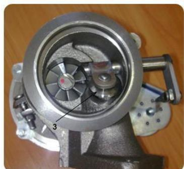
Рис. 1. Турбокомпрессор с перепускным устройством: 1 – рычаги управления заслонкой; 2 – пневматическая камера управления; 3 – заслонка
