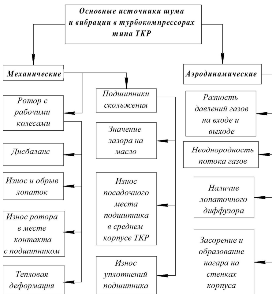
Рис. 2. Классификация источников шума и вибраций в турбокомпрессорах
